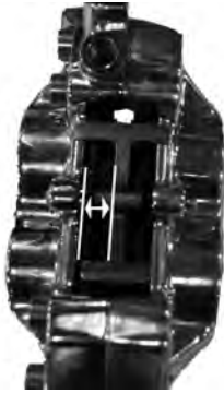
Figure 33 : mesure de l'étrier de frein
