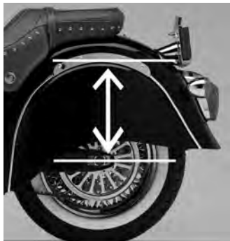
Figure 15 : mesure du jeu de la suspension
