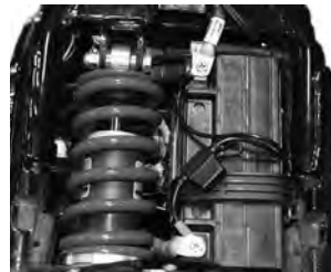
Figure 30 : batterie après le retrait de la selle
